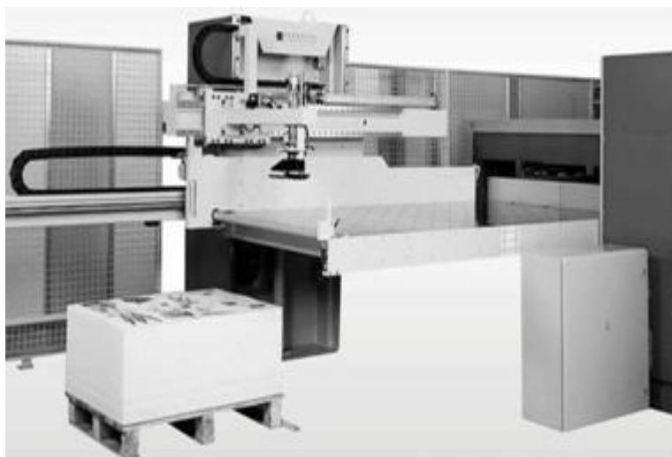
Устройство за зареждане на хартия ВВ 6 на книгоvezки нож Perfecta 168 TVC за автоматично зареждане на задната маса
